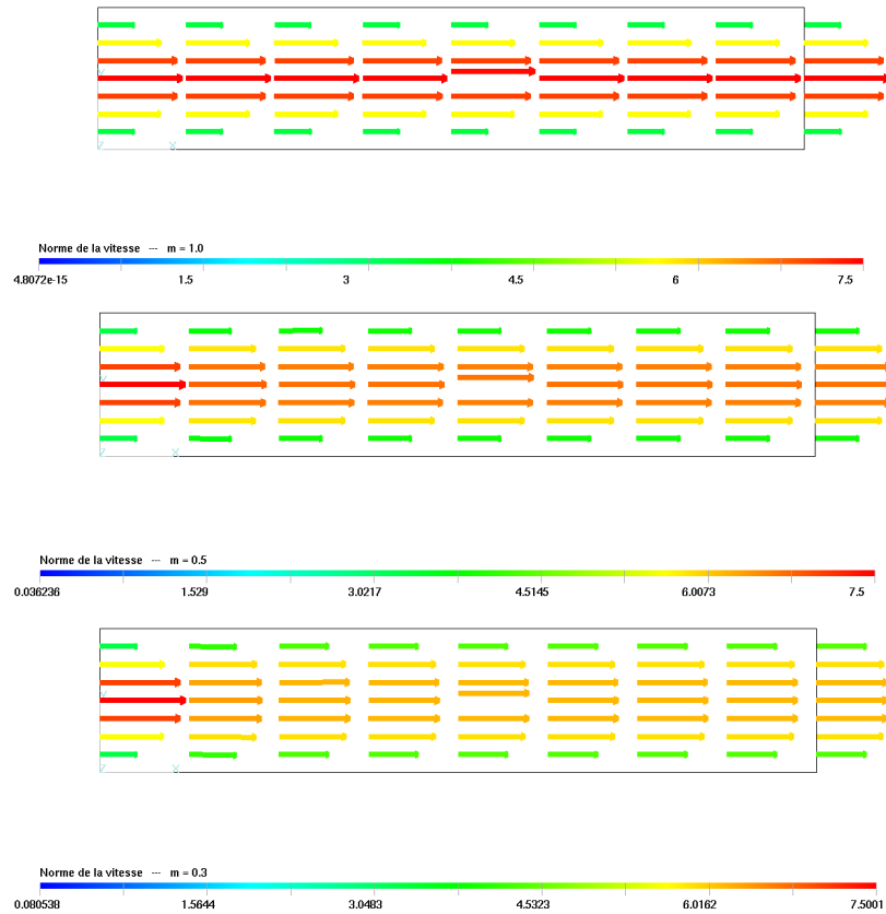
Figure 12.17 – Écoulement de Poiseuille : loi puissance avec m = 1 , m = 0,5 et m = 0,3
