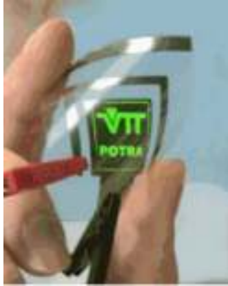
Fig. 35. Un écran souple OLED
