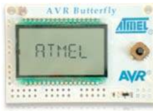
Fig. 6. Une carte microcontrôleur avec affichage LCD
