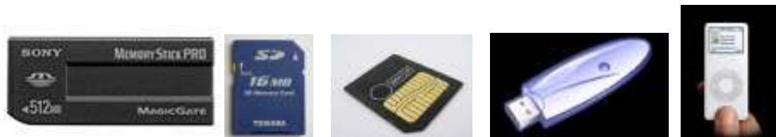
Fig. 4. Différents formats de mémoires flash (dont une clé USB et un lecteur mp3)
