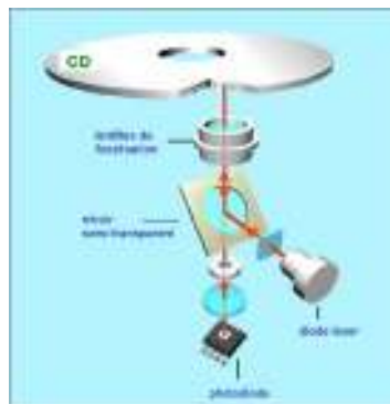
Fig. 6. Système optique de lecture par réflexion
