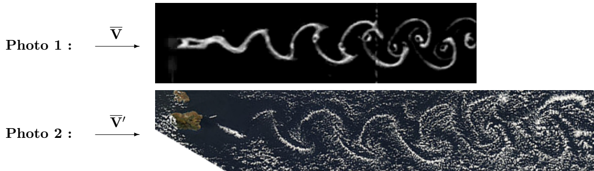
Fig. 8.6 – Photographies de phénomènes de lâcher de vortex de Bénard-Von-Karman derrière des obstacles. Photo 1 : expérience en canal hydraulique réalisée à l'ONERA ; l'obstacle est un cylindre ; du colorant a été injecté pour tracer les lignes d'émission. Photo 2 : prise au-dessus de l'île volcanique de Santo Antao par le satellite Terra ; l'écoulement de l'air atmosphérique est visible grâce à des nuages.
