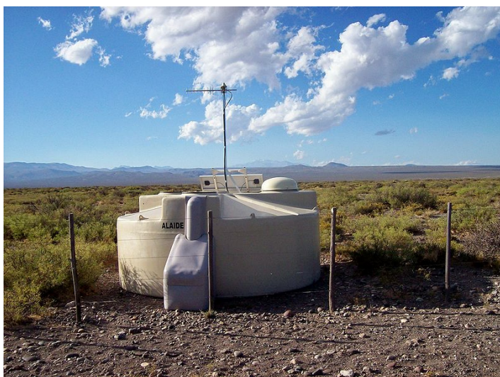
Figure 3 : L'un des 1600 « détecteurs de surface » de l'observatoire Pierre Auger disposés dans la pampa argentine et recevant la lumière Cherenkov des cascades de particules créées par les rayons cosmiques de très grande énergie. Auger dispose également de « télescopes de fluorescence » détectant la lumière ultraviolette émise par les molécules de l'air excitées par les particules. Ce type d'observatoire est unique dans le monde par sa dualité fluorescence-Cherenkov.
