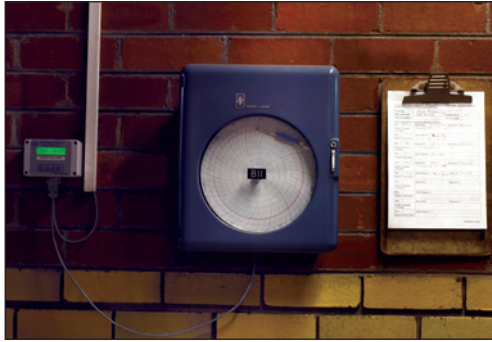
Enregistreur permanent avec autonomie de 7 jours
