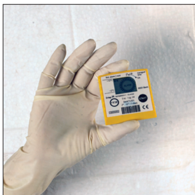
Enregistreur électronique de température utilisé pour le transport du sang
