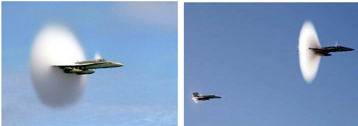
FIGURE 13.3. Franchissement du mur de son
