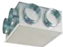
Ensemble de reprise équipé de piquages circulaires (2 pour 18/30 et 4 pour 25/60) et d'une grille démontable avec filtre. Le modèle 18/30 est adapté au montage entre fermettes en maison individuelle. Le modèle 25/60 s'adapte aux faux-plafonds modulaires 600 x 600.
