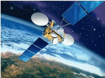
Les équipements de télécommunication (répéteurs) assurent les mêmes fonctions qu'un relais hertzien : ils reçoivent les émissions provenant de la Terre et les réémettent vers la Terre après amplification et transposition de fréquence. Les antennes associées à ces répéteurs sont spécialement conçues pour assurer la couverture des régions de la Terre intéressées par le réseau satellite.
