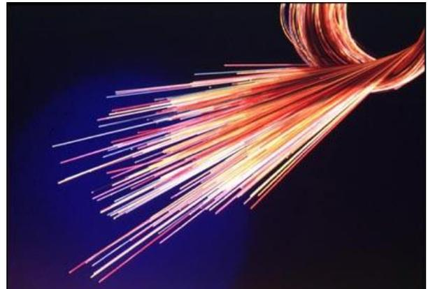
Depuis plus de cent ans, TYNDALL a montré comment, dans une fontaine lumineuse, un faisceau de lumière pouvait être guidé dans un milieu transparent. Il suffit qu'un deuxième milieu, d'indice de réfraction inférieur, entoure le premier milieu. La lumière se réfléchit alors à la surface de séparation des deux milieux, c'est la réflexion totale, bien plus parfaite que la réflexion sur une surface métallique.
