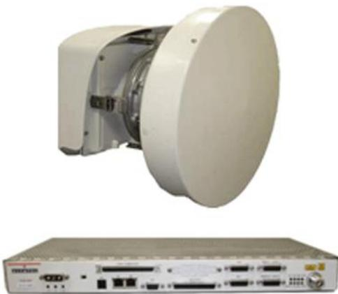
**Faisceau hertzien** - Liaison par radio à très haute fréquence. Utilisé pour transmettre des émissions de télévision ou de radio, quelquefois pour le téléphone dans des régions difficiles d'accès ou en secours du réseau terrestre, encore assez rarement pour les données.
