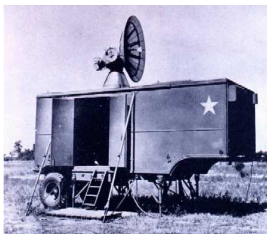
FIGURE 1.13 – Système de RADAR SRC-584 (US-Army)[17]
