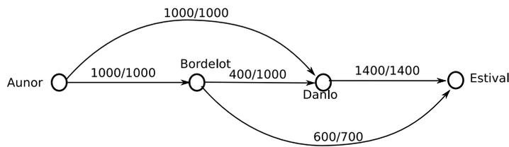
FIG. 2.46 – Flot après amélioration : il s’agit du flot maximal
