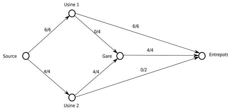
FIG. 2.53 – Premier flot au jugé... et flot maximal
