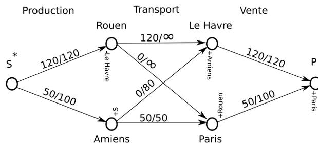
FIG. 2.30 – Marquage de Ford-Fulkerson sur le flot initial
