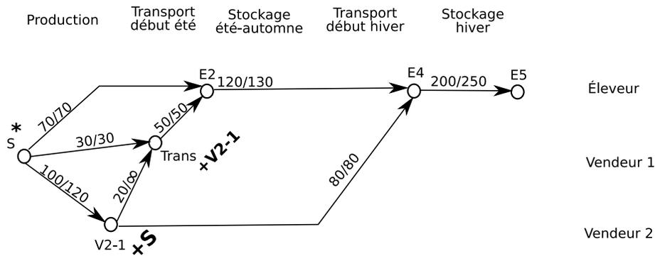
FIG. 2.60 – Calcul du flot maximal (unité : tonne)
