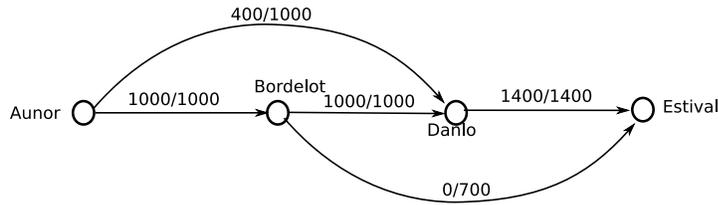
FIG. 2.44 – Flot initial pour commencer l’algorithme de Ford-Fulkerson
