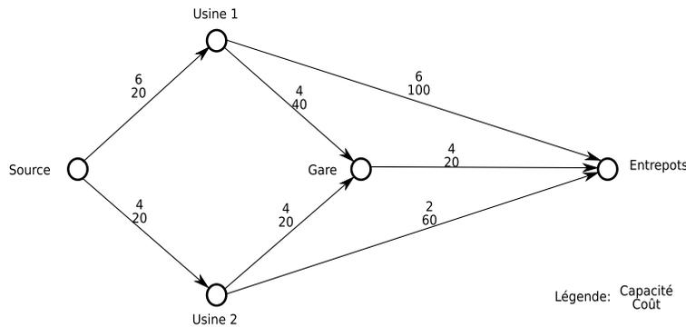
FIG. 2.54 – Modélisation du flot maximal à coût minimal
