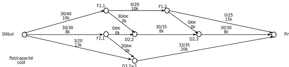
FIG. 2.27 – Solution optimale pour 63 élèves
