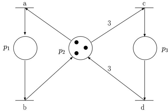
FIG. 3.1 – Exemple de réseau de Petri
