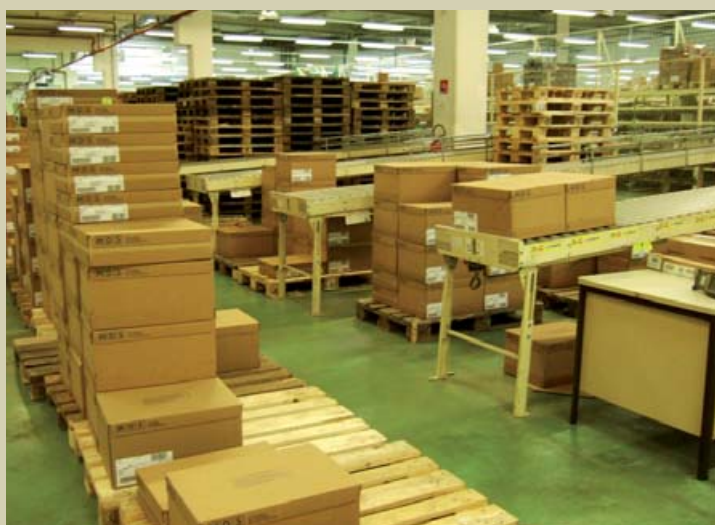
8. Expédition. Les colis sont dirigés vers l'une des lignes de tri correspondant aux transporteurs pour palettisation manuelle. Les colis sont scannés individuellement pour être associés à un numéro de palette. Puis les palettes sont chargées dans un camion garé à l'un des 7 quais.
