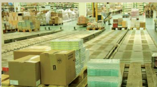
3. Zone de Dispatch. Pour optimiser les déplacements des caristes, les missions de réapprovisionnements sont multi lignes de préparation. Elles sont redistribuées par ligne de préparation afin d'être prises en charge par un seul rangeur. Muni d'un terminal radio, ce dernier scanne l'étiquette de la mission et visualise ainsi l'adresse de rangement. Une fois scannée cette dernière, le produit est considéré comme disponible dans l'emplacement de préparation. En cas d'erreur, le rangeur est alerté.
