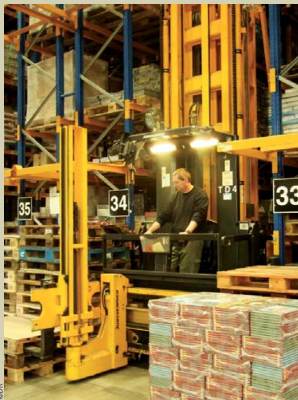
2. Rangement. Embarqués dans des chariots tri-directionnels filoguidés, les caristes rangent les palettes déchargées des camions dans le palettier de 36.000 emplacements. Equipés en radiofréquence, ils réalisent des inventaires tournants et prélèvent palettes et colis pour réapprovisionner les zones de préparation (environ 1.000 réapprovisionnements par jour).
