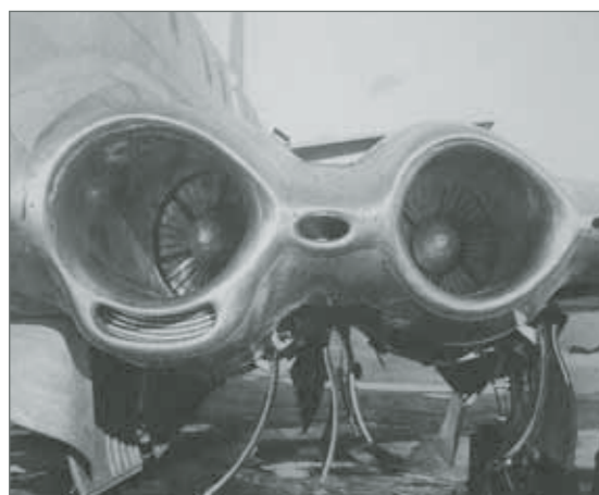
Installation des réacteurs Ghost dans l'emplanture des ailes du Comet.
